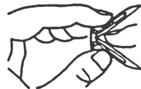
Fig. 17 - Cómo doblar el soporte de expansión
