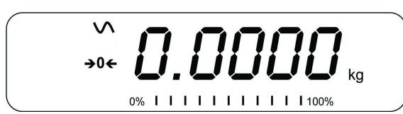
Las básculas tienen una función automática de cero para justificar menor movimiento o acumulación de materia en una plataforma conectada. Sin embargo, se necesitará pulsar **[Zero]** para regresar la báscula a cero si una pequeña cantidad de peso todavía es indicado cuando el plato está vacío.
