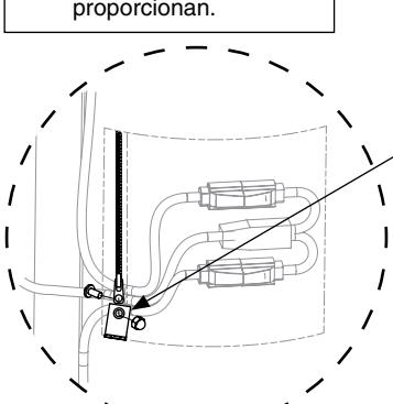
**D** Enrute el cable eléctrico fuera de la parte inferior de la ranura de gancho y bucle en el camisa calentadora. Fije las regletas de gancho y bucle en la ranura del camisa calentadora. Tire firmemente del cordón en la parte superior del camisa calentadora.
