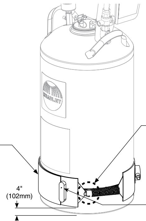
**B** Use alicates o una herramienta similar para fijar la correa del calentador al tanque.
