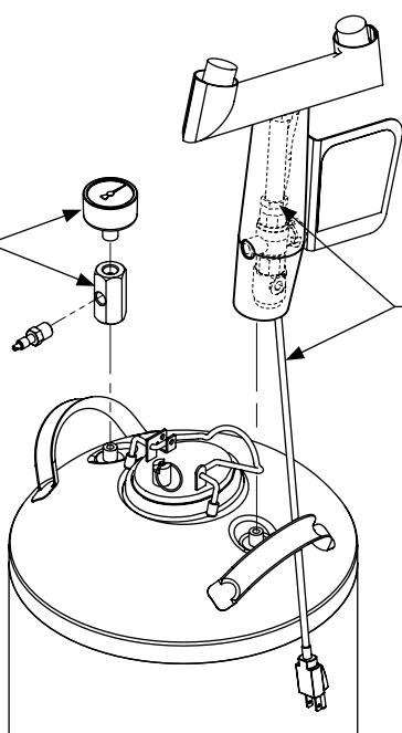
**A** Monter la douche oculaire sur l'orifice de sortie du réservoir. Couple maximum 150 in-lbs. Passez le câble dans la manette du réservoir.
