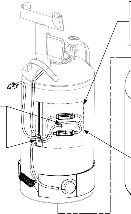
**A** Alinee la cavidad en el camisa calentadora, directamente al lado del yugo del lavaojos, lejos del resorte de retención en la base del calentador. Deslice el camisa calentadora hacia fuera del tanque.
