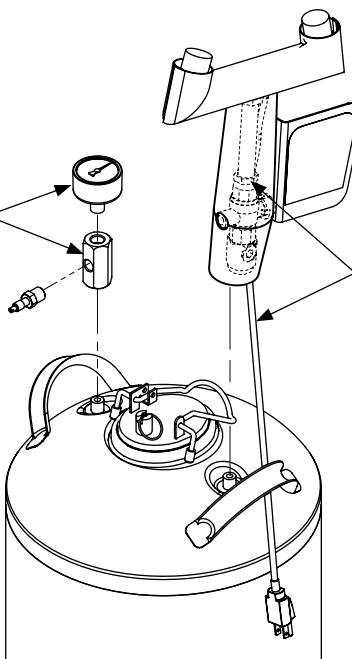
**A** Montar el conjunto de la horquilla del lavaojos al tanque. Esfuerzo de torsión máximo 150 in-lbs. Pase el cable a través del manija del tanque.
