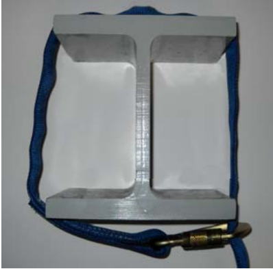
Conexión correcta del amarre
