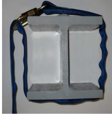
Conexión incorrecta del amarre
