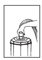
Asegúrese de que la tapa se enrosca y se bloquea en la aspiradora. Tome la manguera de la aspiradora y empuje en la abertura redonda en la parte superior de la tapa.
