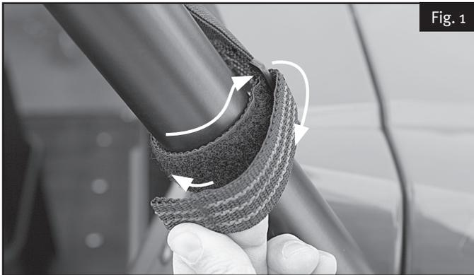
2. Ajustez les sangles supérieures puis les sangles inférieures afin de centrer le pare-brise entre les montants de la cage de retournement (voir Fig. 2). Après l'avoir centré et vous être assuré qu'il est à correctement à niveau, serrez toutes les sangles.
