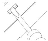
Utilisez un tournevis plat pour appuyer sur la fente à Les deux côtés pour détacher la coque avant.
