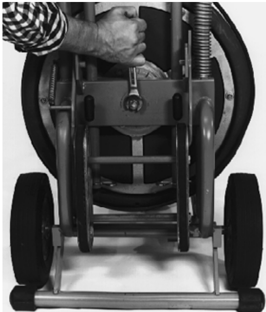
Figura 19 – Extracción del perno en el soporte trasero
