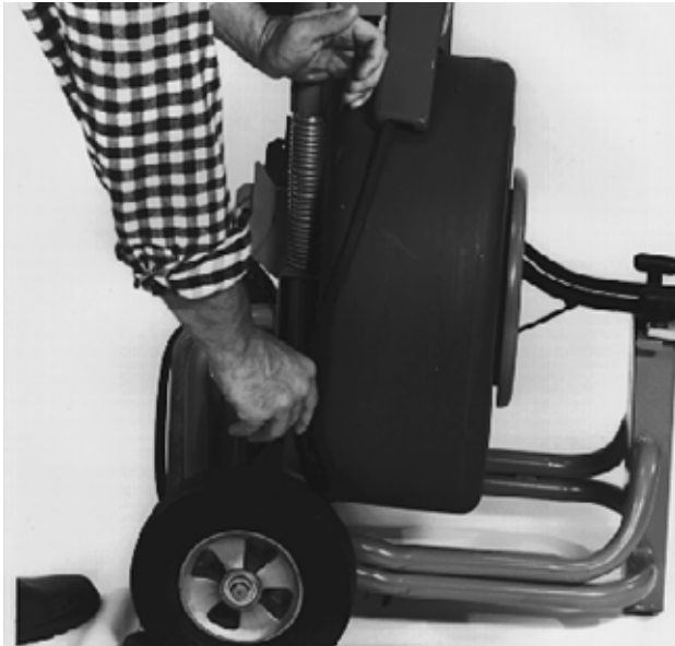
Figura 18 – Afloje la tensión de la correa
