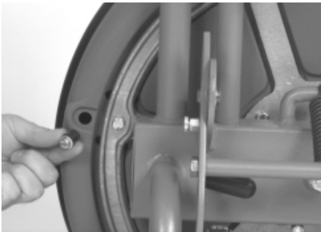
Figura 13 – Tapón de tornillo en agujero para desaguar el tambor
